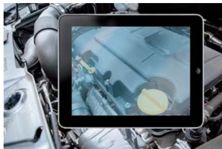
Augmented Reality im Einsatz: Auf einer Datenbrille, einem Smartphone-Display oder einem Tablet wird im Detail angezeigt, wo und wie welcher Handgriff ausgeführt werden muss.
